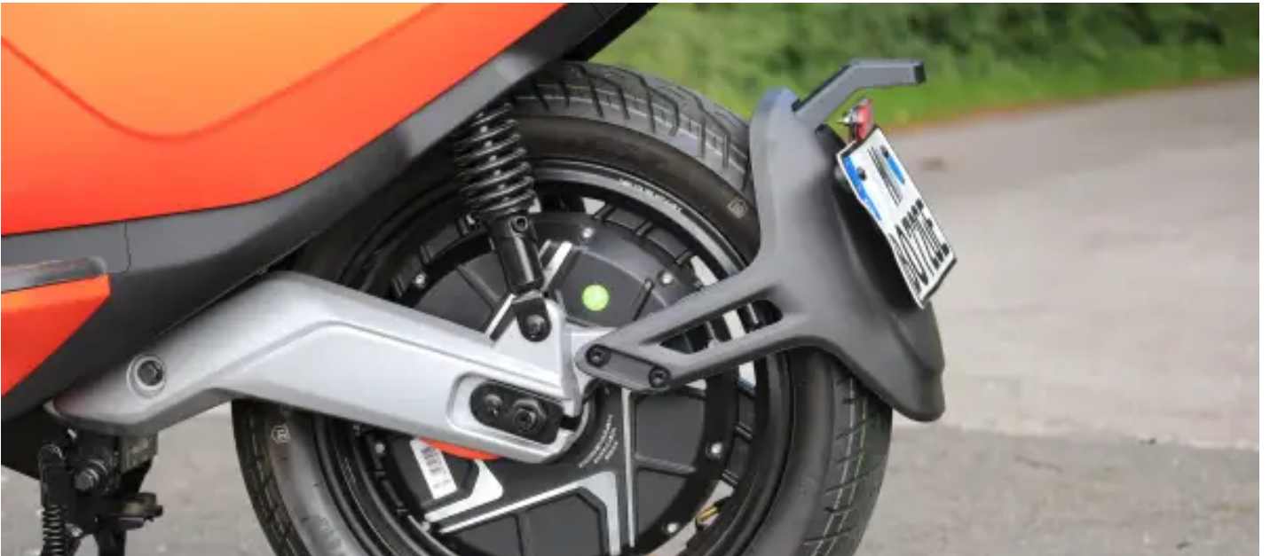
Der Radnabenmotor des Niu leistet in der Spitze 8,2 PS, die Dauerleistung beträgt 6,8 PS • © RKM
