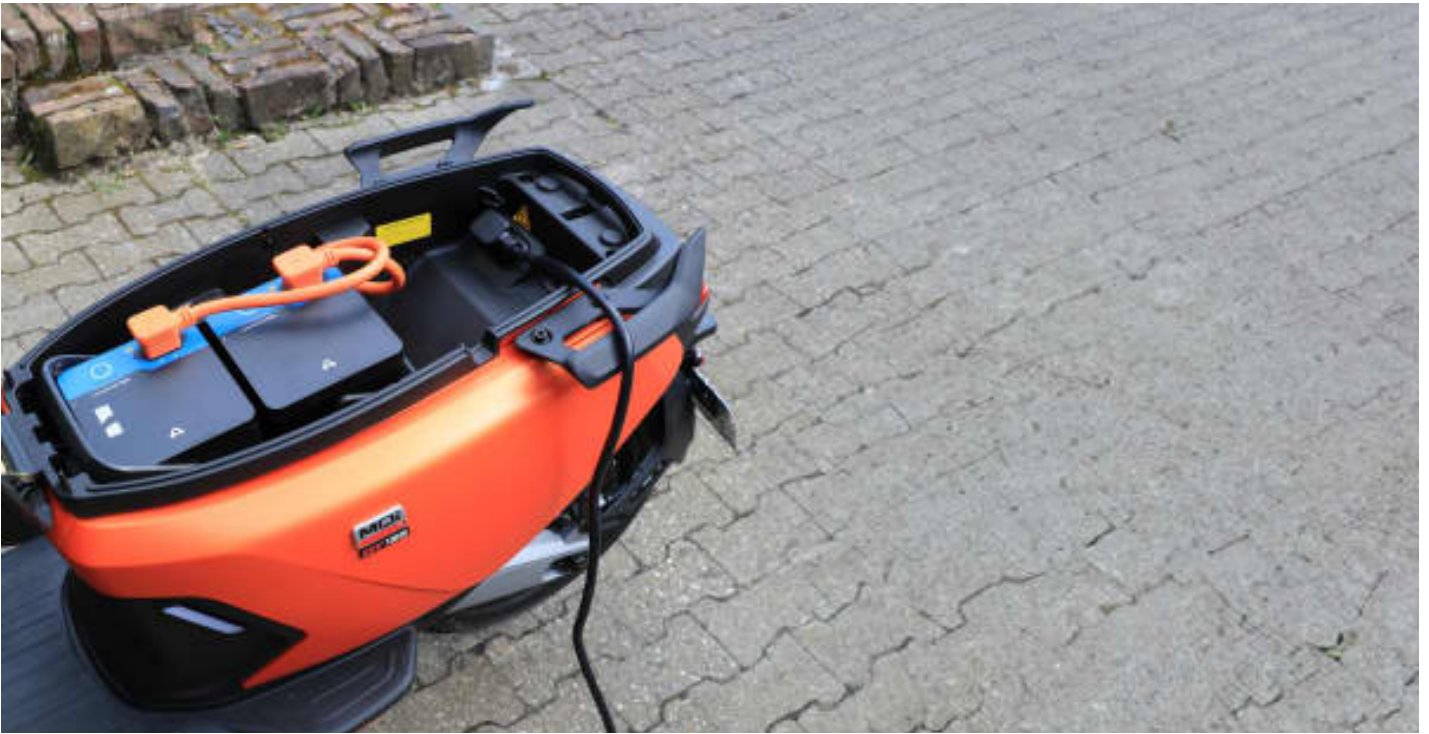
Energiequelle: Der Niu hat zwei Akkus mit je 1,87 kWh unter der Sitzbank • © RKM
